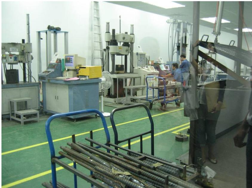
圖八、測定鋼筋的銲接強度(破壞性)
